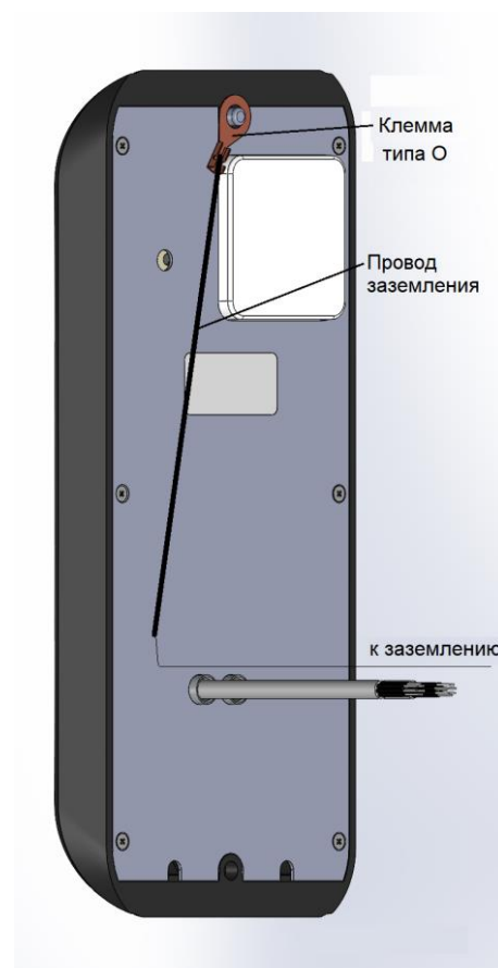
Рис.2.2 Подключение провода заземления к блоку вызова
